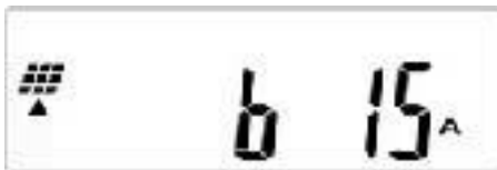
Fig. 7-4 - 9 Display O - String B current
