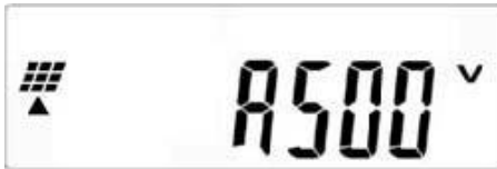
Fig. 7-4 - 6 Display L - String A voltage
